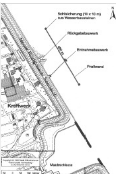
Abb. 1: Kraftwerk mit Kühlwasserabfluss, geplanter Prallwand und Kühlwasserentnahme mit Saugleitung Richtung Deich (gestrichelt); südlich davon das Maadesiel
