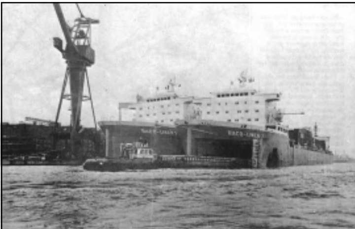
Baco-Liner 1 und Baco-Liner 2: Dockschiffe mit 2 Bugtoren; 22.345 BRT; 21.801 tdw; 201,4 m lang, 28,53 m breit, max. Tiefgang 6,65 m. Baujahre 1979, 1980 und 1984 (Baco-Liner 3), Thyssen Nordseewerke, Emden
